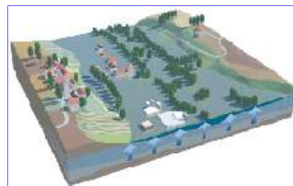
Inondation par remontée de nappe phréatique © Graphies, Alp'Géorisques
